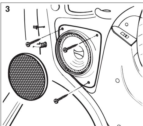
**I** Effettuare i cablaggi dell'altoparlante. Fissare altoparlante e la mascherina Phonocar al pannello mediante le viti fornite in dotazione. Facendo pressione incastrare la griglia nella predisposizione.
